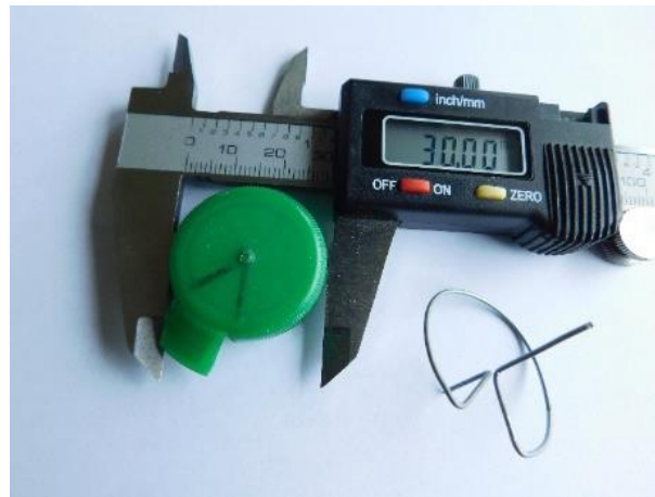
Obr. 2 Elementární šablona pro výrobu setrvačnicku
